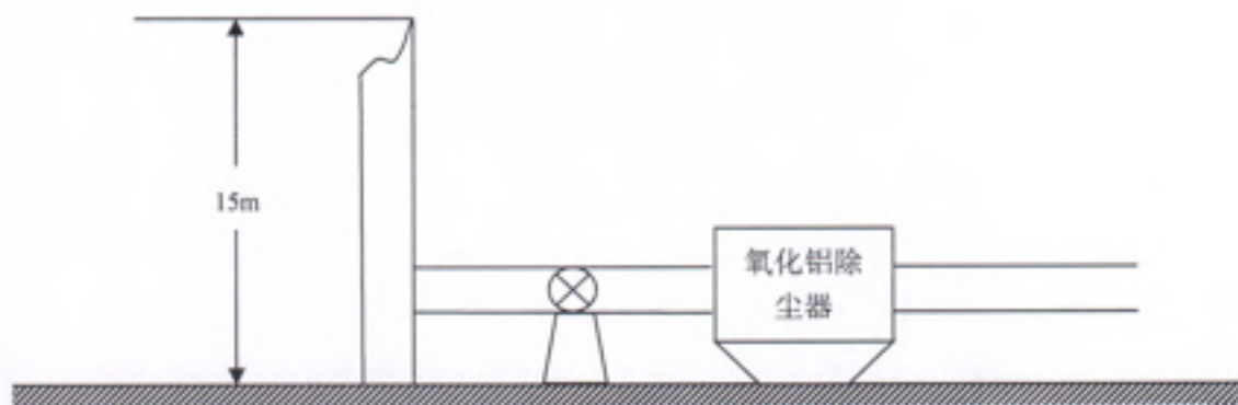
附图 4 氧化铝上料废气排气筒出口监测点位示意图
