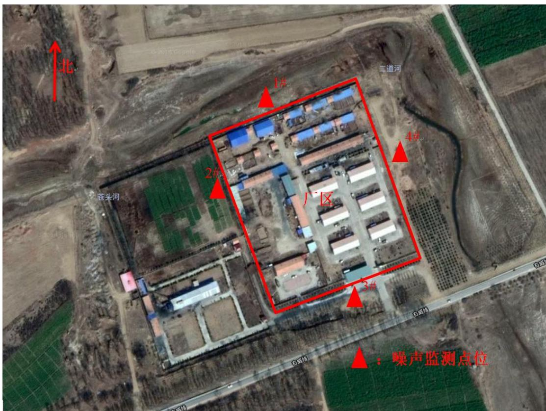
图3-2 噪声测点示意图
