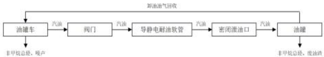
图 1-1 汽油卸油与产污工艺流程图
