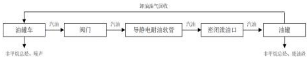
图 1-1 汽油卸油与产污工艺流程图
