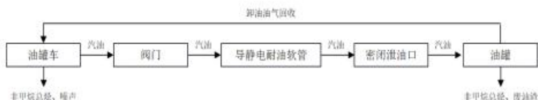
图 1-1 汽油卸油与产污工艺流程图
