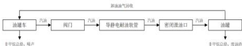
图 1-1 汽油卸油与产污工艺流程图
