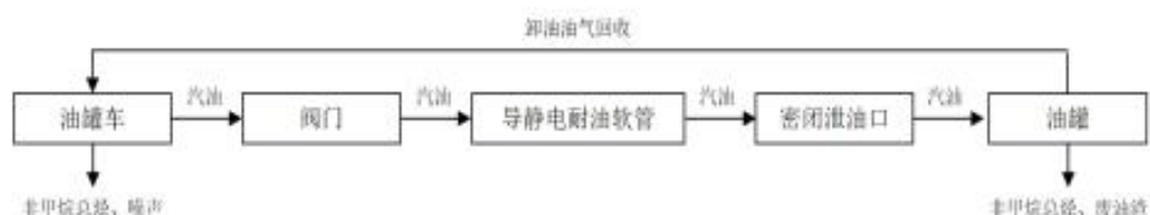
图 1-1 汽油卸油与产污工艺流程图
