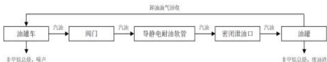
图 1-1 汽油卸油与产污工艺流程图
