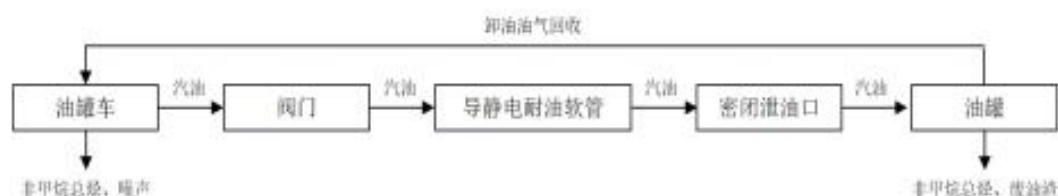
图 1-1 汽油卸油与产污工艺流程图
