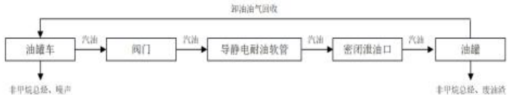
图 1-1 汽油卸油与产污工艺流程图
