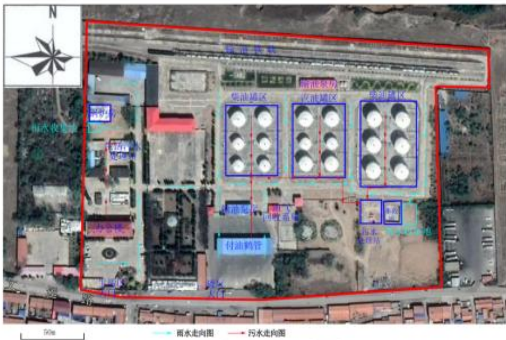
图 1-6 朔州油库雨水和污水管线走向图及平面布置程图
