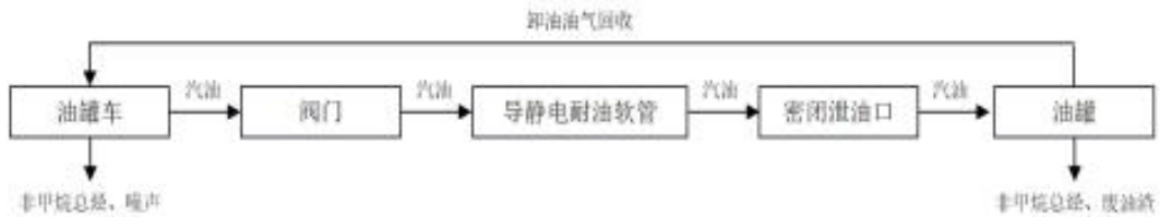
图 1-1 汽油卸油与产污工艺流程图
