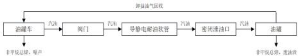
图 1-1 汽油卸油与产污工艺流程图
