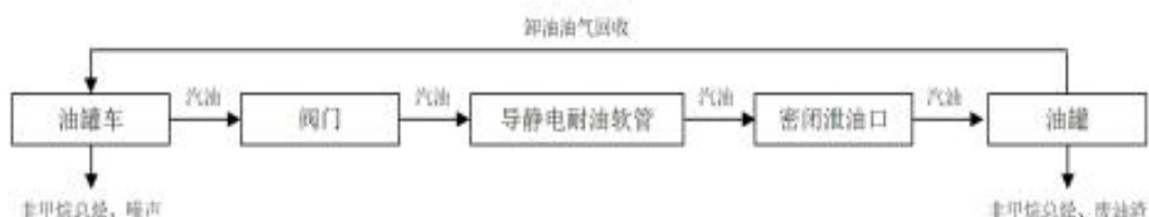
图 1-1 汽油卸油与产污工艺流程图
