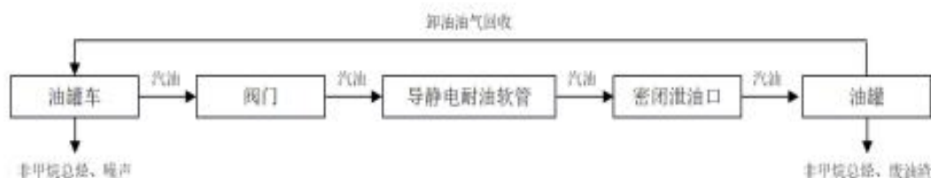
图 1-1 汽油卸油与产污工艺流程图
