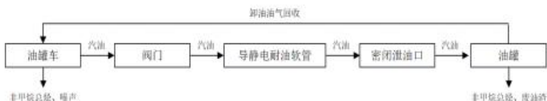
图 1-1 汽油卸油与产污工艺流程图
