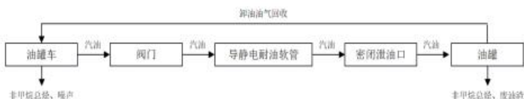
图 1-1 汽油卸油与产污工艺流程图
