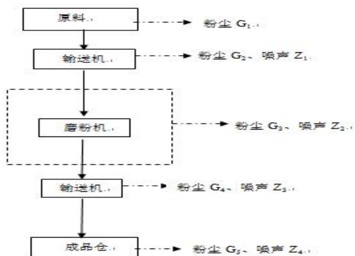
图 1-2 脱硫粉（钙产品深加工）工艺及产排污环节流程图。
