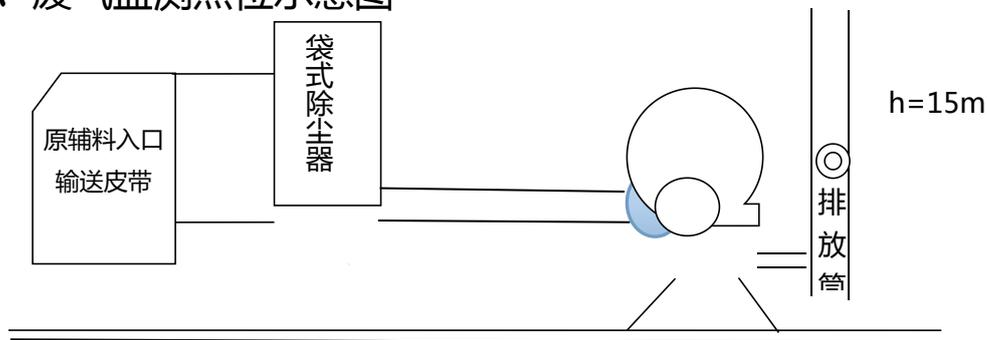
输送皮带除尘器监测点位示意图
