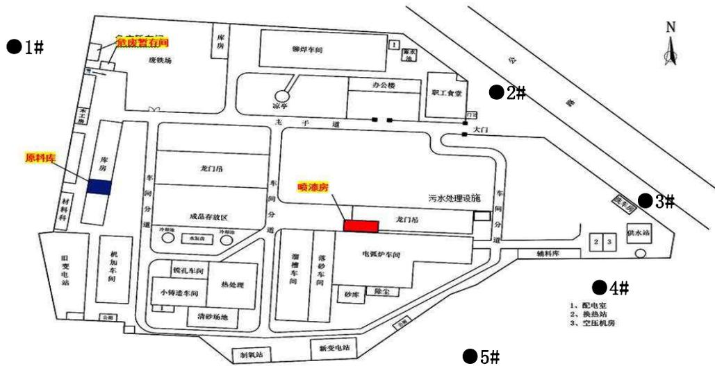
图 3-8 无组织废气监测点位
