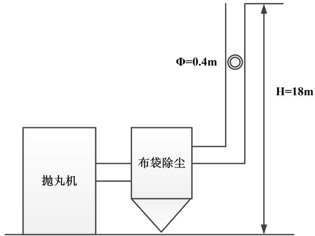
图 3-3 抛丸机排气筒监测点位示意图 (DA003)
