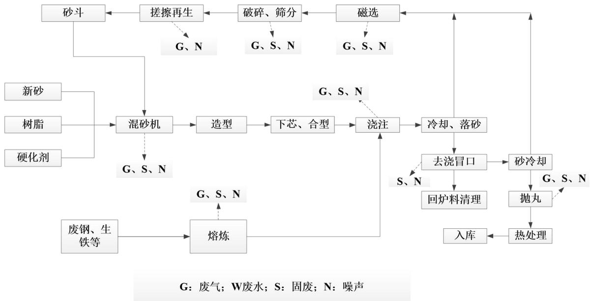
图 1-1 铸钢和铸铁生产工艺流程图及产排污环节
