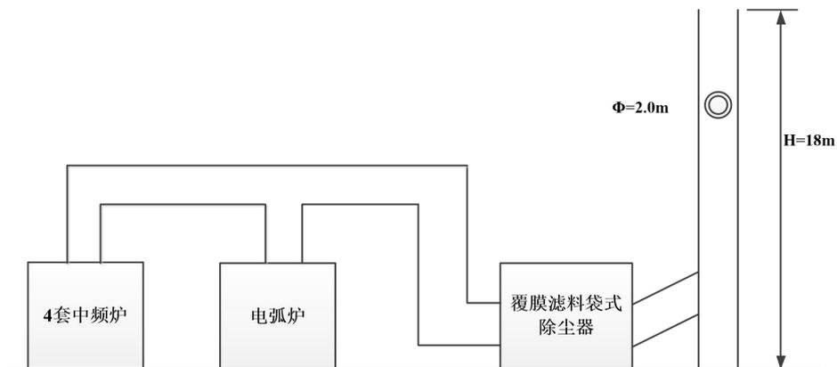
图 3-1 熔炼排气筒监测点位示意图 (DA001)
