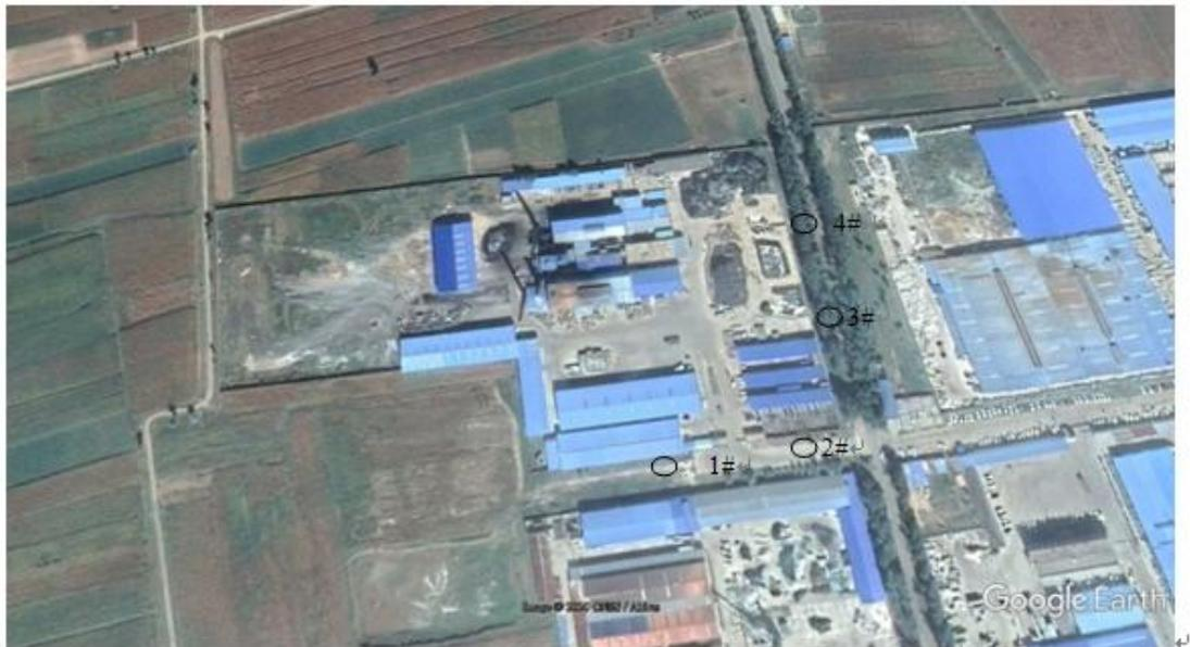
图 3-3 厂界无组织废气监测点位示意图
