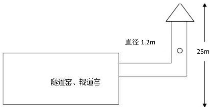
图 3-1 窑炉烟气监测项目监测点位示意图
