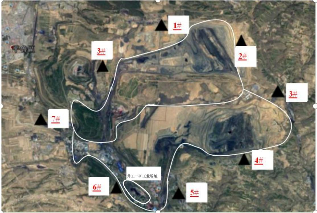
图 3-4 安太堡-安家岭区域厂界噪声监测点位示意图
