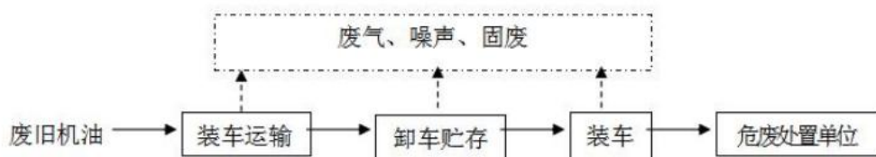
图1-2 废旧机油周转流程及产污环节图
