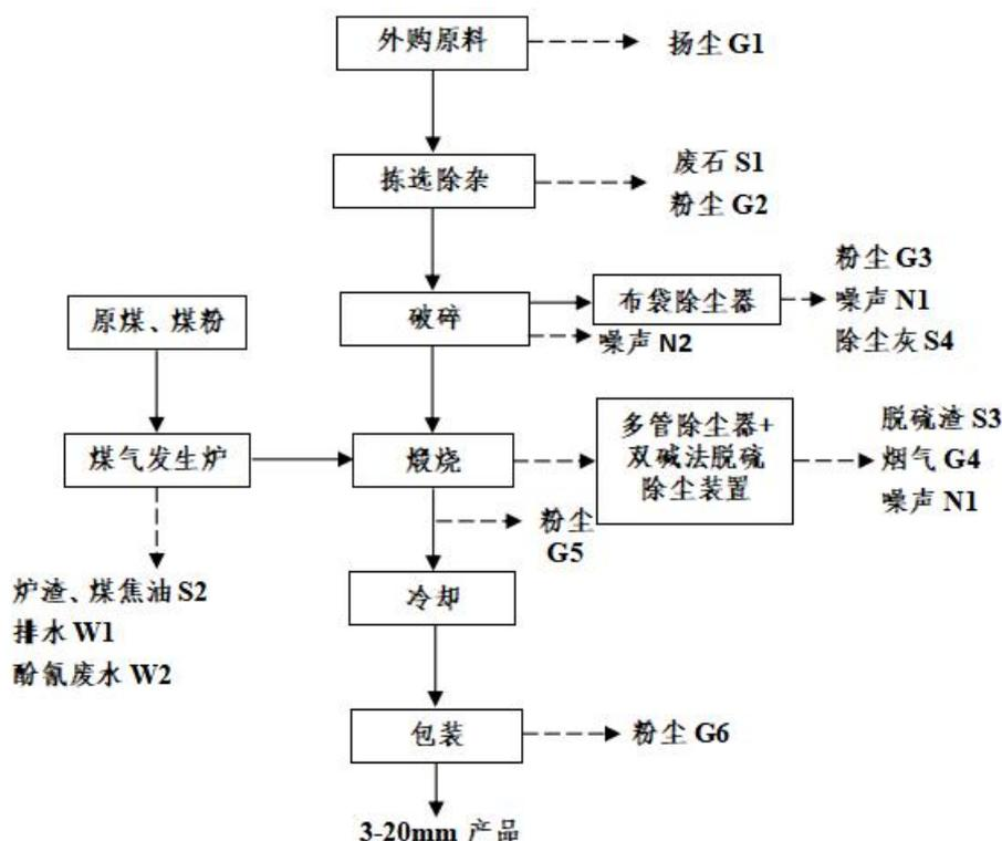
图 1-2 回转窑项目工艺流程及产排污环节图
