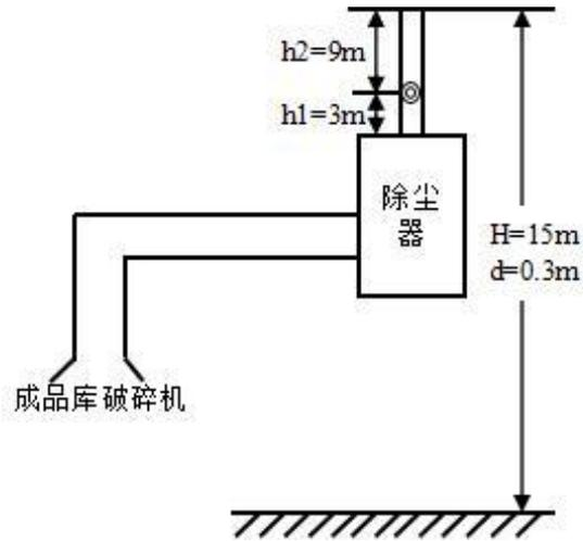
图 3-4 成品库锤破废气排放口监测点位示意图 (DA004)
