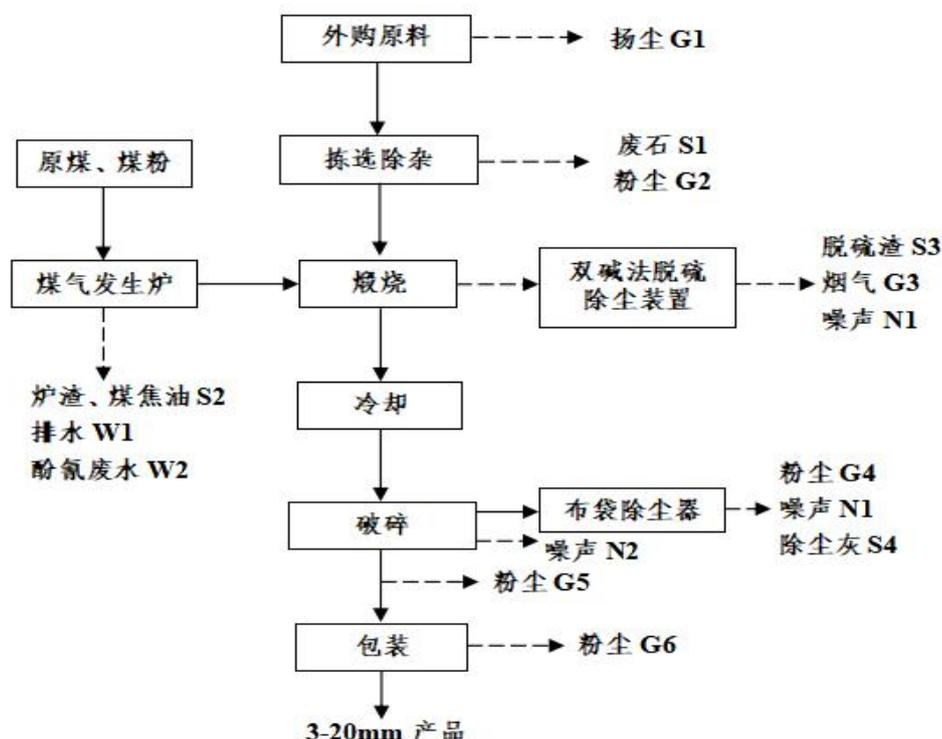
图 1-1 环式节能窑工艺流程图
