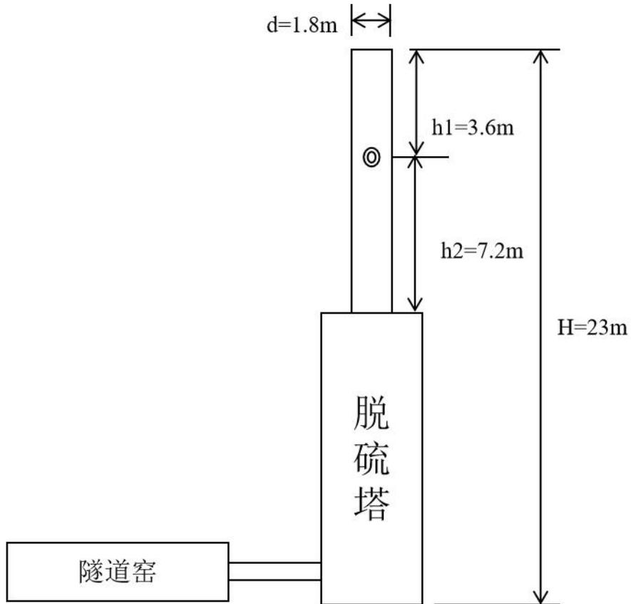
图3-2 隧道窑废气排放口监测点位示意图
