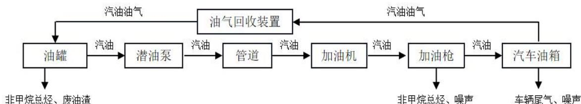
图 1-2 汽油加油与产污工艺流程图
