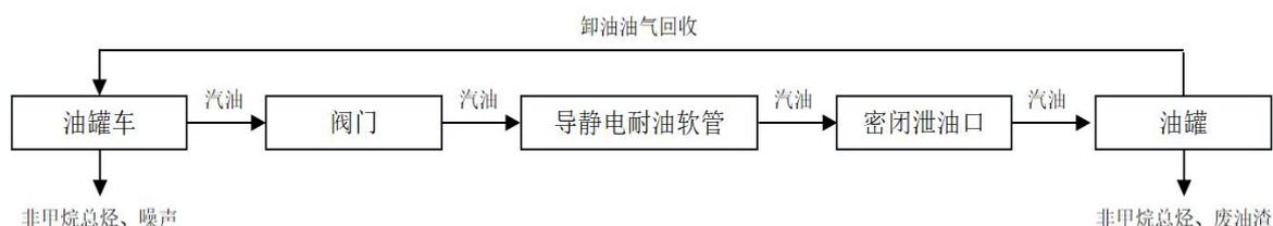
图 1-1 汽油卸油与产污工艺流程图
