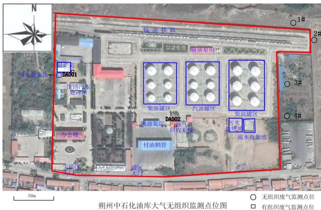
图 3-3 朔州油库监测点位布设图 (注：注以实际监测时气象条件为准)
