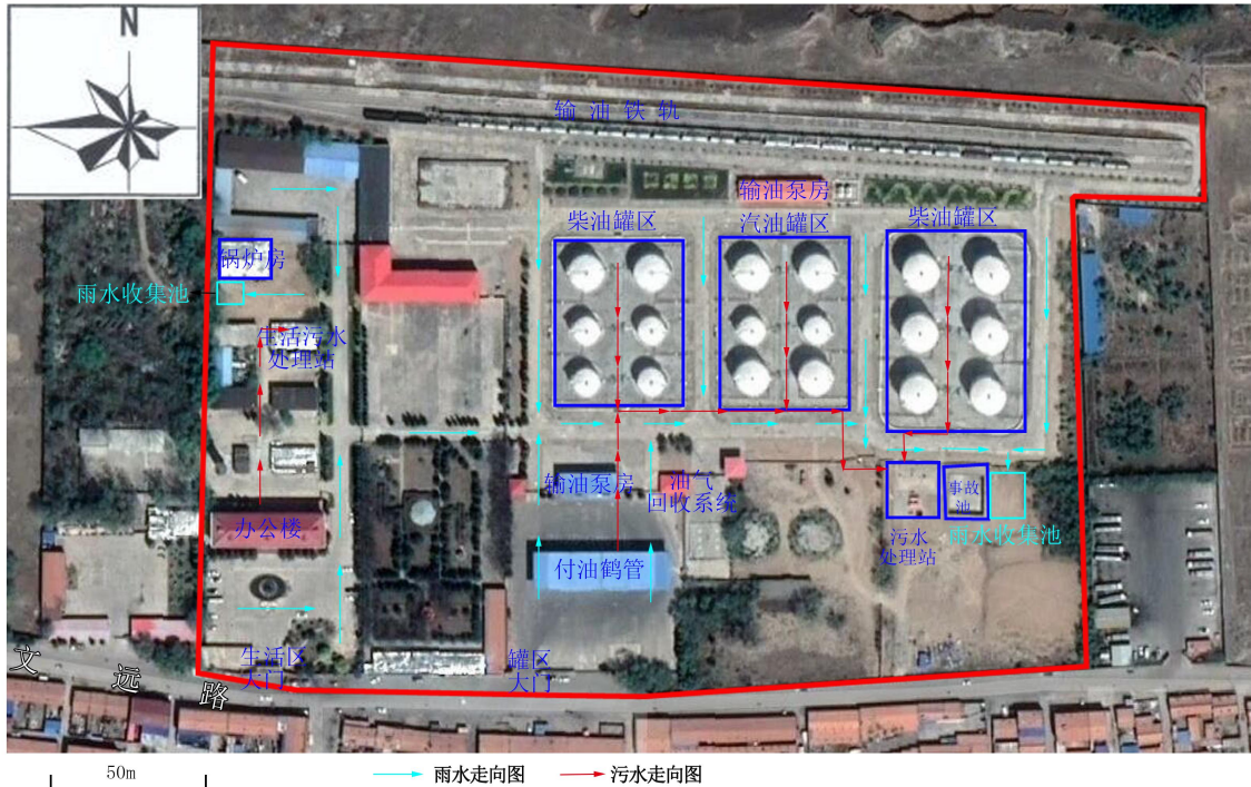
图 1-6 朔州油库雨水和污水管线走向图及平面布置程图
