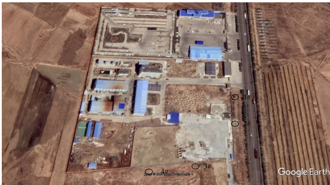
图 3-5 厂界无组织废气监测点位示意图
