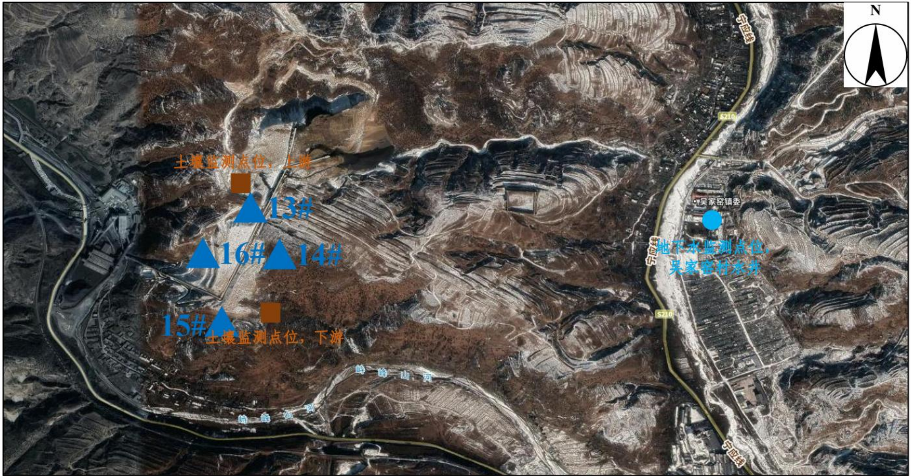
图3-6 矸石场噪声及土壤、地下水监测布点
