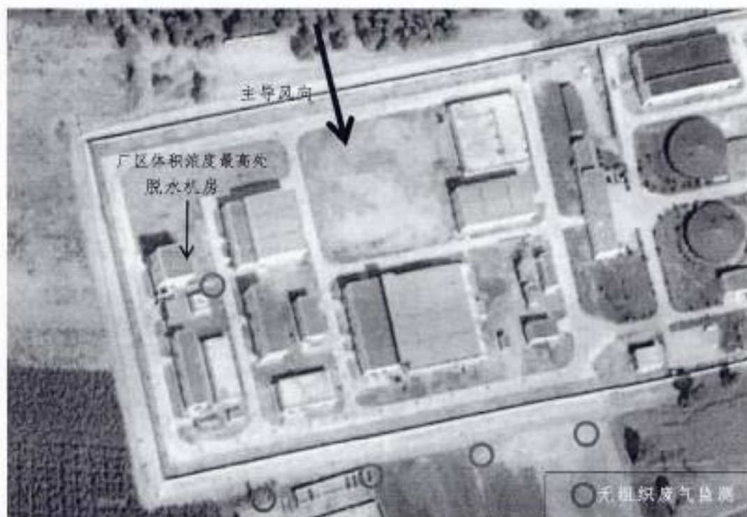
图 3-1 厂界无组织废气监测点位示意图
