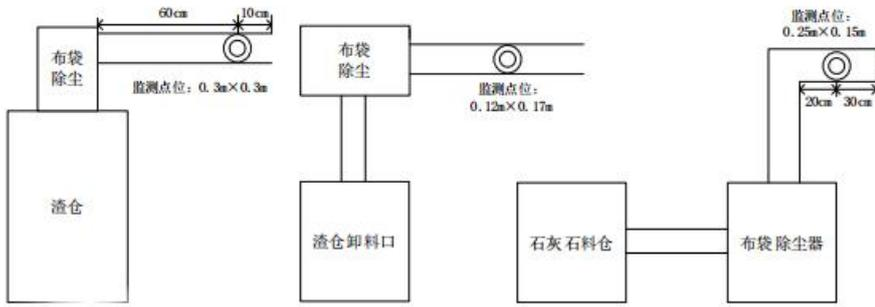
渣仓、渣仓卸料口、石灰石料仓除尘器监测点位示意图
