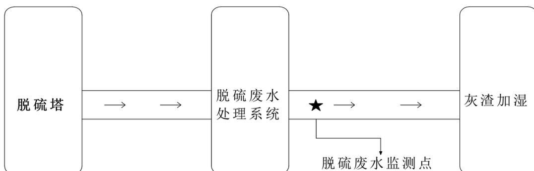
**图 4 脱硫废水监测点位示意图**
