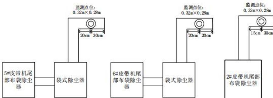
5#、6#、2#皮带机尾部除尘器监测点位示意图
