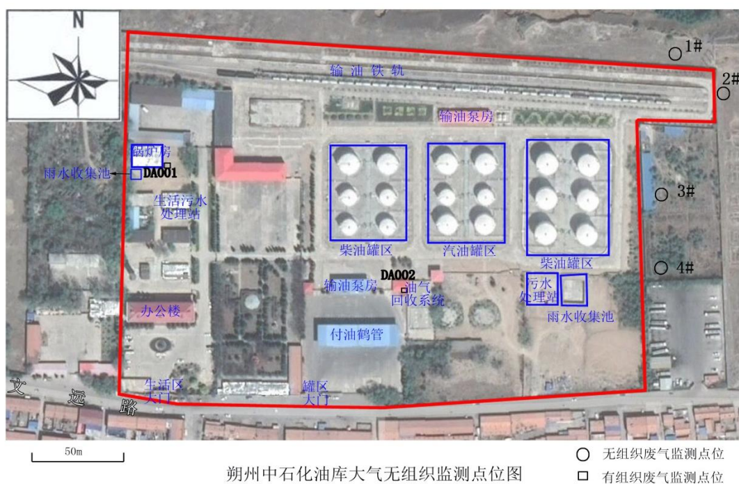
图 3-4 朔州油库监测点位布设图（注：注以实际监测时气象条件为准）
