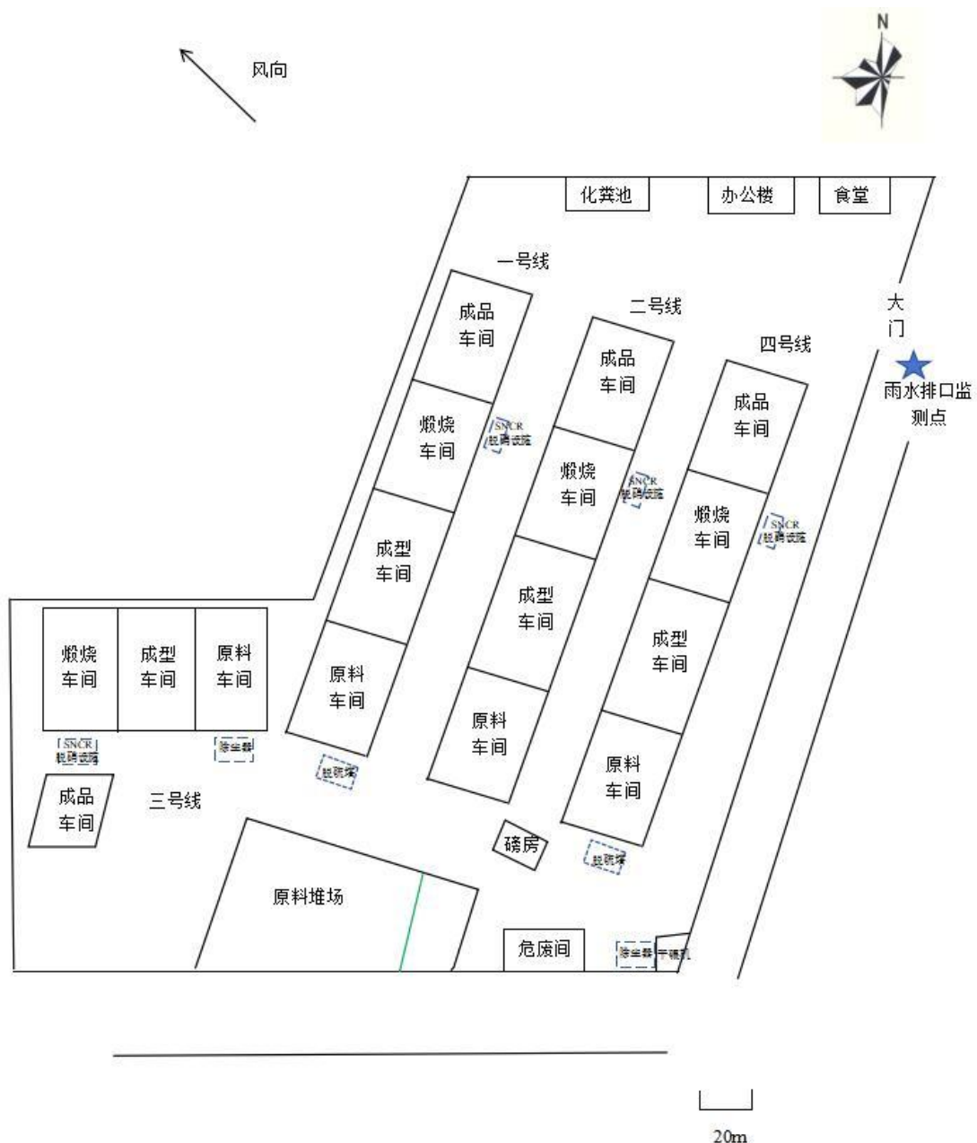
图 3-8 废水监测点位示意图
