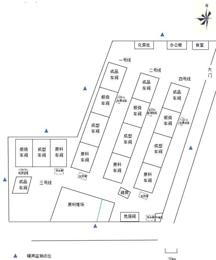
图 3-9 厂界噪声监测布点示意图
