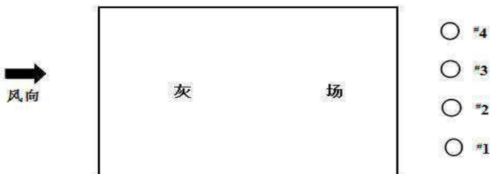
图 3-4 离地高度大于 15 米的有组织颗粒物监测点位示意图
