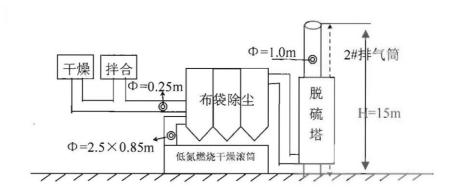
3 冷料落料点、干燥滚筒、振动筛、拌合监测点位示意图
