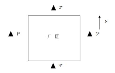
图 3-5 厂界噪声监测布点示意图
