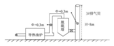
4 导热油炉进、出口监测点位示意图
