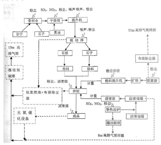
图 1-1 沥青混凝土工艺流程图及产排污环节
