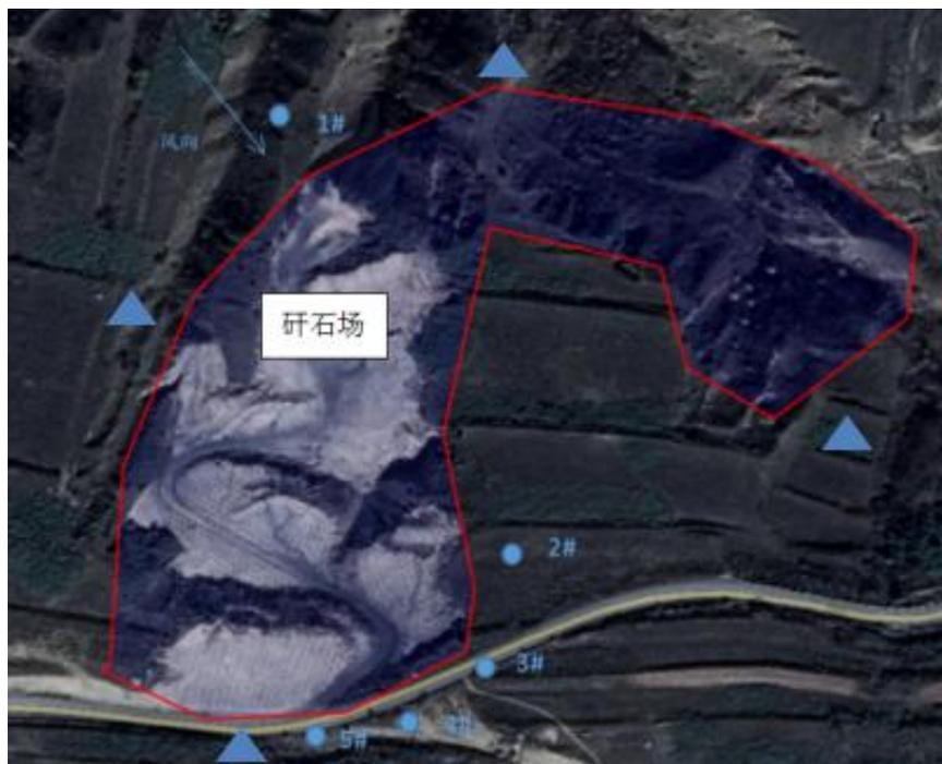
图 3-6 矸石场界噪声监测布点示意图
