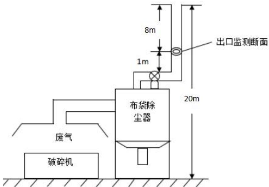
图 3-6 破碎机废气监测点位图
