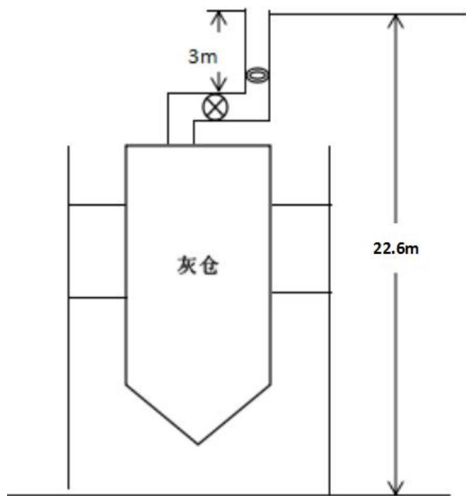
图 3-4 灰仓废气监测点位图
