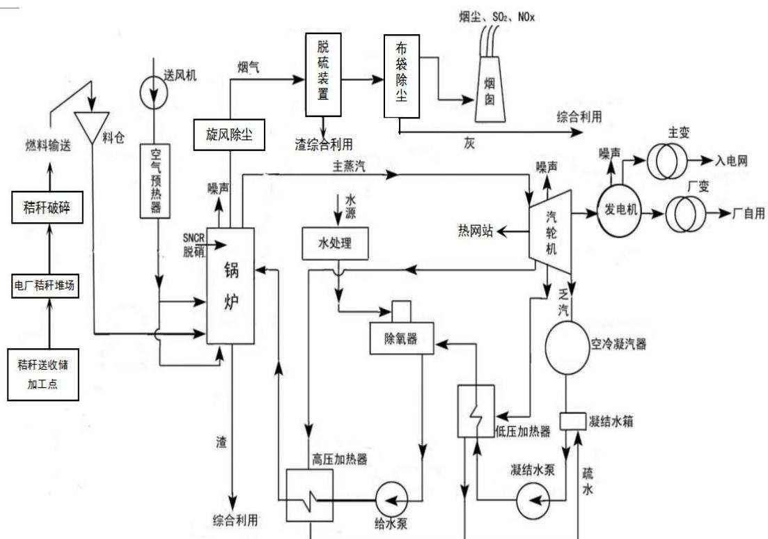
图 1-1 项目工艺流程及产污节点
