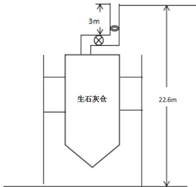
图 3-3 生石灰仓废气监测点位图
