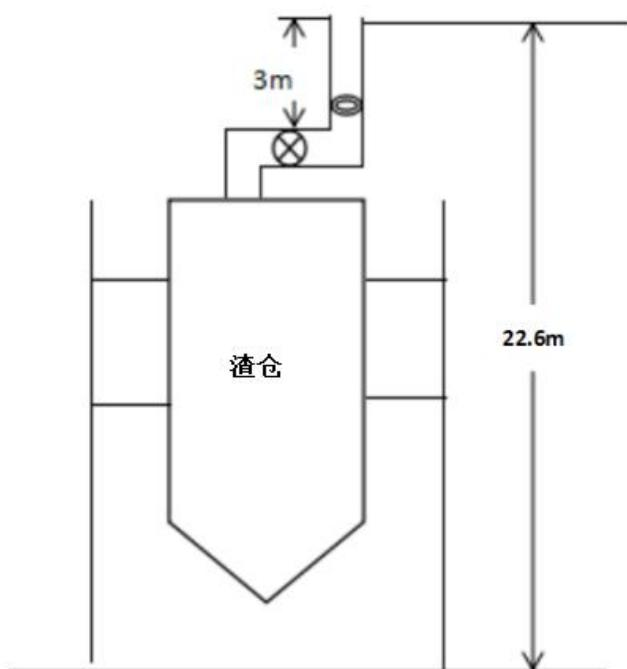
图 3-5 渣仓废气监测点位图
