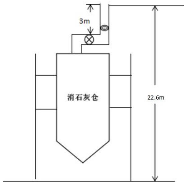
图 3-2 消石灰仓废气监测点位图
