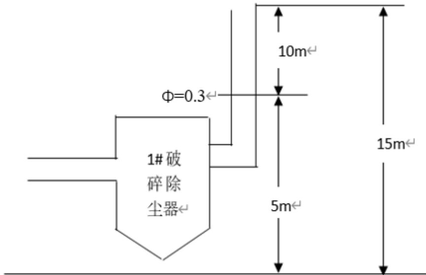
图 1 1#破碎废气手工监测点位示意图
