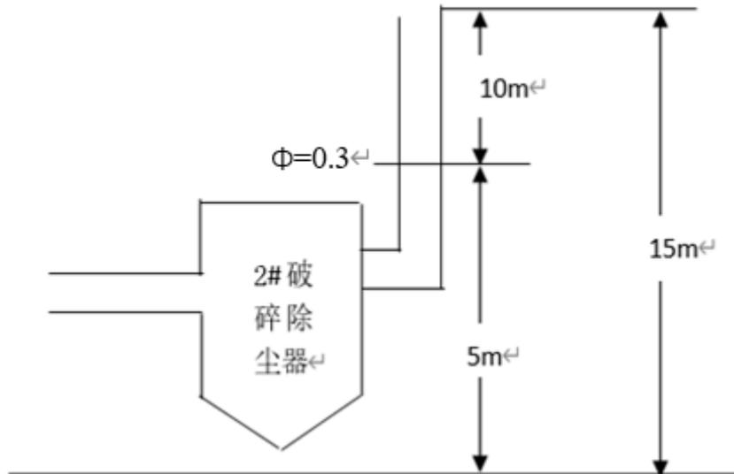
图 2 2#破碎废气手工监测点位示意图
