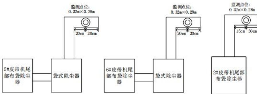
图 3-6 5#、6#、2#皮带机尾部除尘器监测点位示意图
