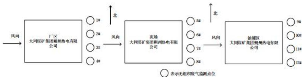
图 3-7 厂界、油罐区、灰场无组织监测点位示意图
