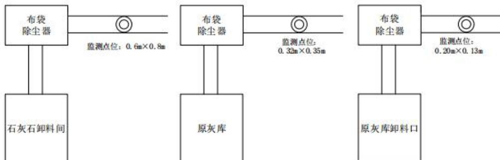
石灰石卸料间、原灰库、原灰库卸料口除尘器监测点位示意图
