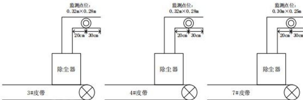
3#、4#、7#皮带机尾部除尘器监测点位示意图
