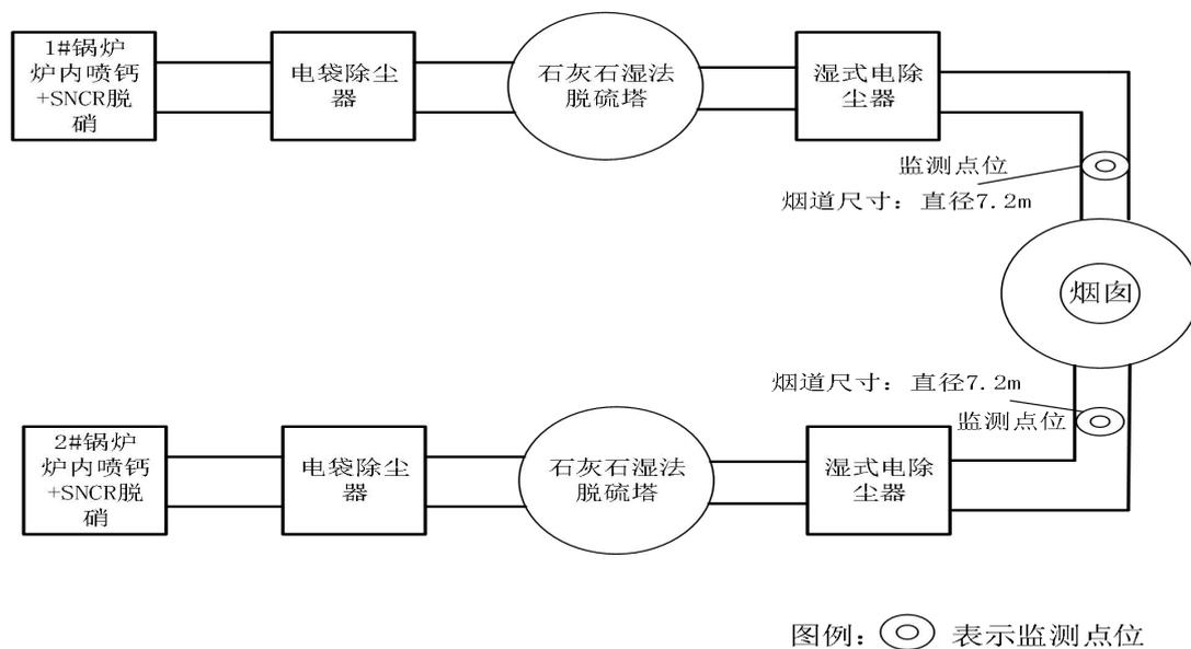
图 1 1#锅炉（机组）、2#锅炉（机组）废气监测点位示意图
