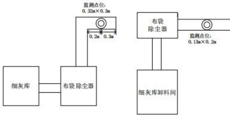
图 3-5 细灰库、细灰库卸料间除尘器监测点位示意图
