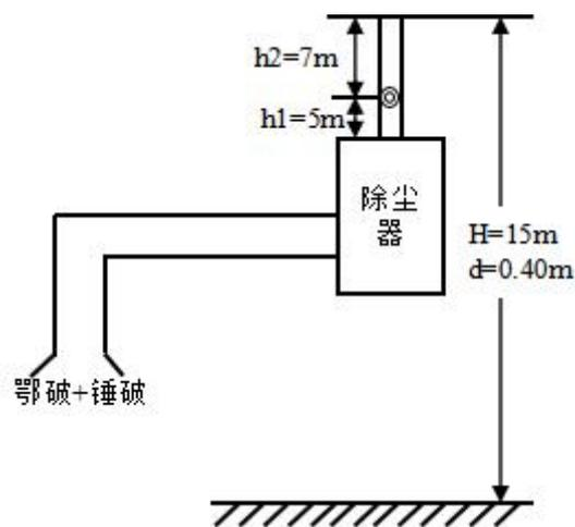
图3-2 破碎废气排放口监测点位示意图
