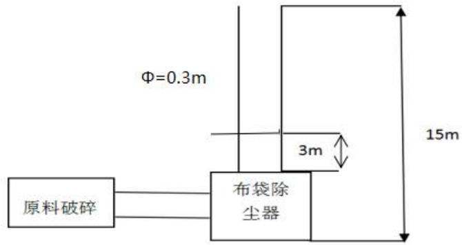
图 1 1#、2#破碎废气手工监测点位示意图
