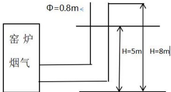
图 3 窑炉烟气手工监测项目监测点位示意图
