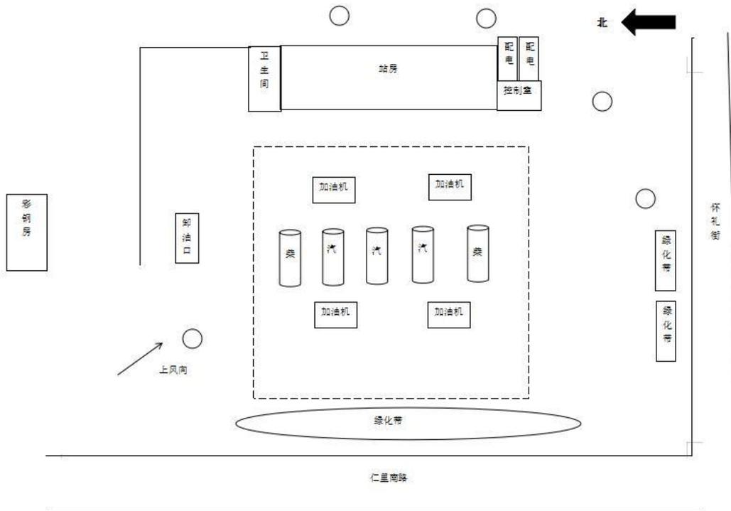
图 3-2 无组织废气监测点位示意图
