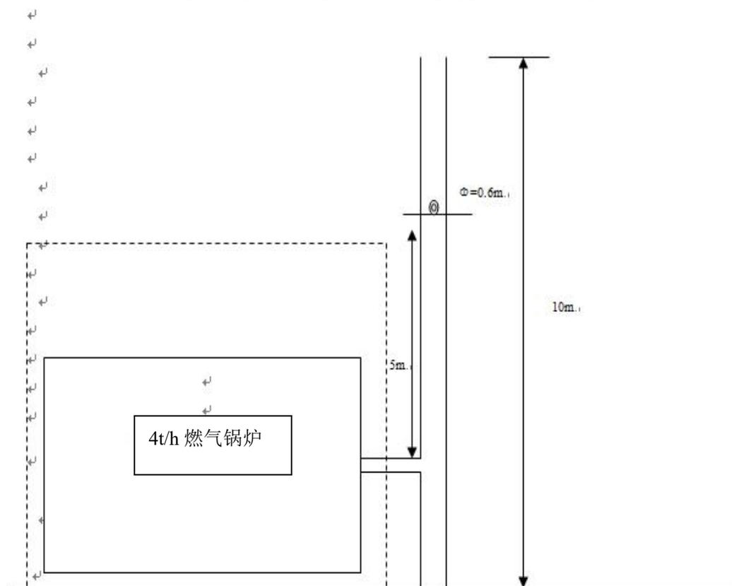
图 3-3 锅炉废气监测点位示意图 (DA003)
