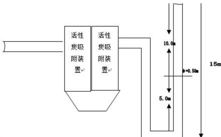
图 3-1 白乳胶、真空泵尾气与出料口废气监测点位示意图
