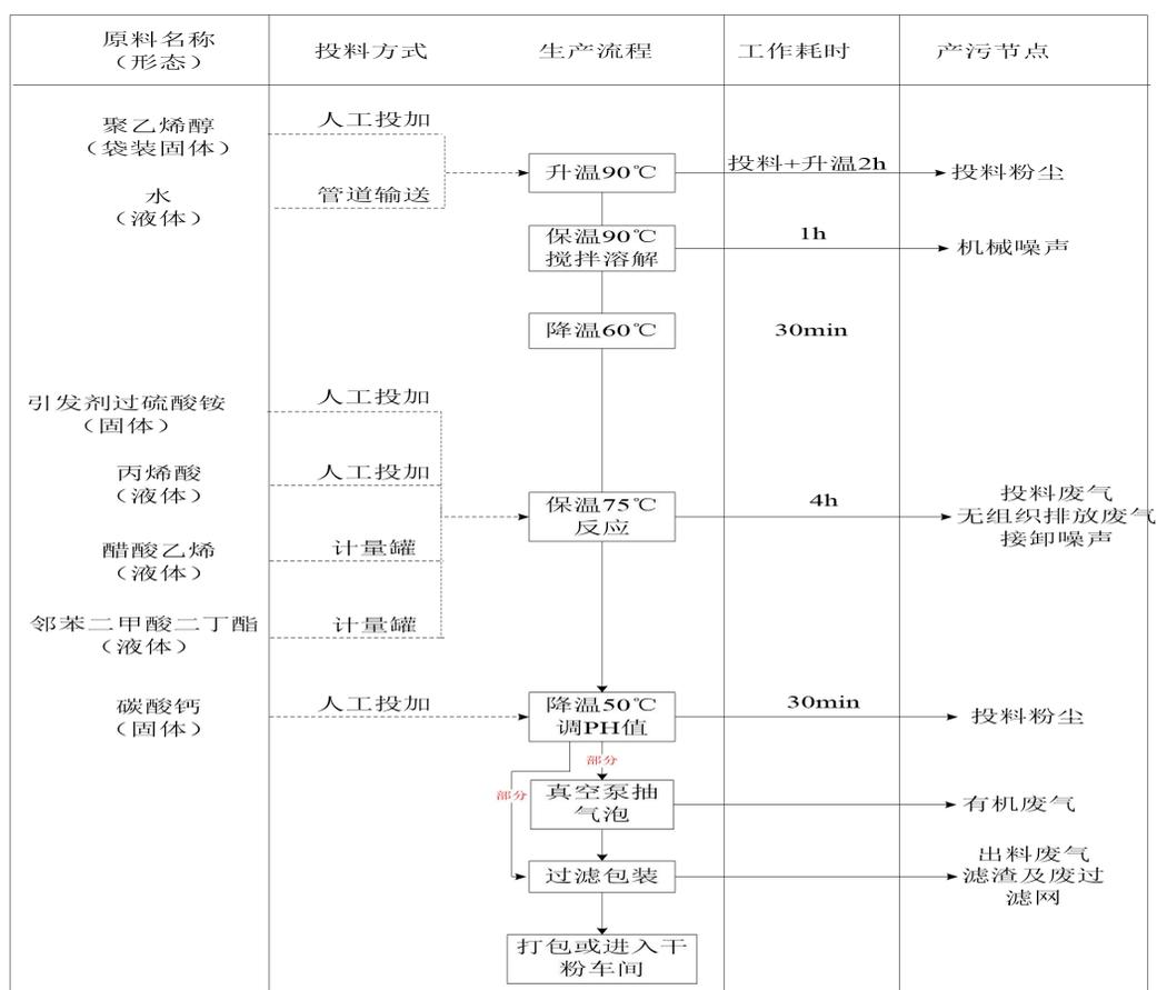
图 1-2 白乳胶生产工艺及产排环节流程图
