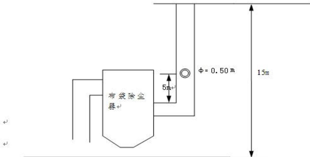
图 3-2 干混砂浆生产线混合机出料废气监测点位示意图 (DA002)
