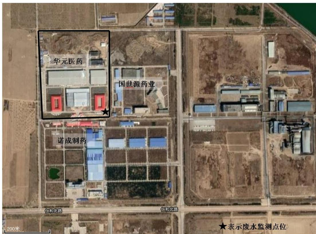
图 3-4 污水处理站排放口监测点位示意图
