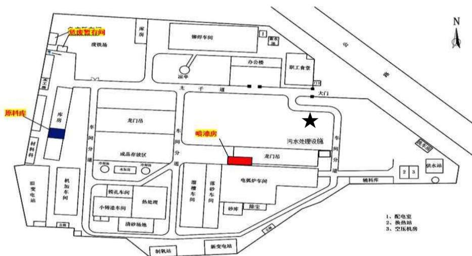
图 3-9 废水监测点位示意图
