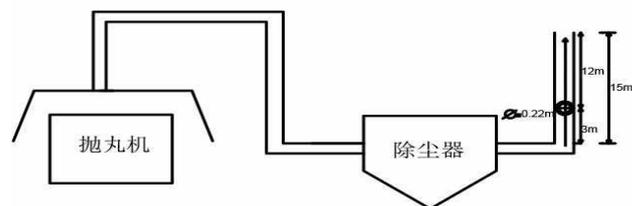
图 3-3 抛丸机监测点位示意图
