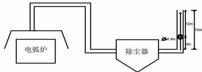
图 3-1 电弧炉监测点位示意图
