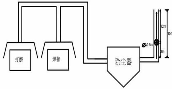
图 3-4 打磨及焊接监测点位示意图
