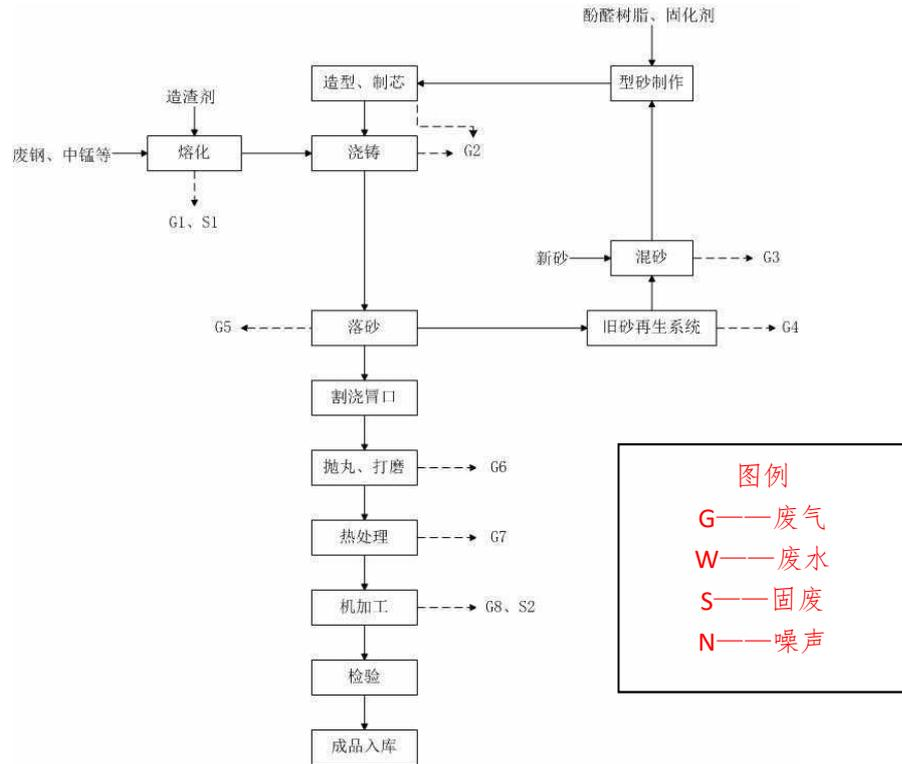
图 1-1 生产工艺及产排污环节流程图
