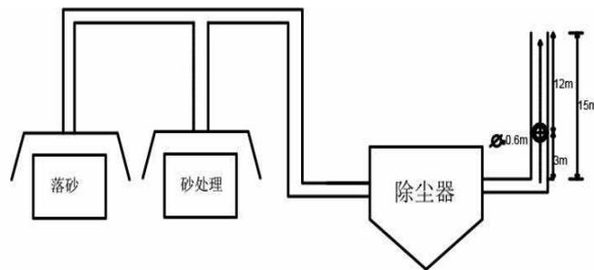
图 3-2 落砂及砂处理监测点位示意图
