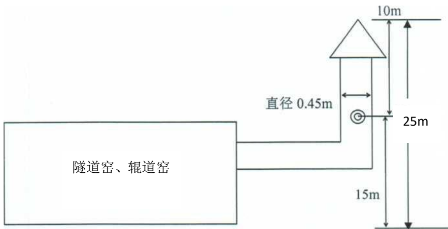
图 3-2 窑炉烟气手工监测项目监测点位示意图
