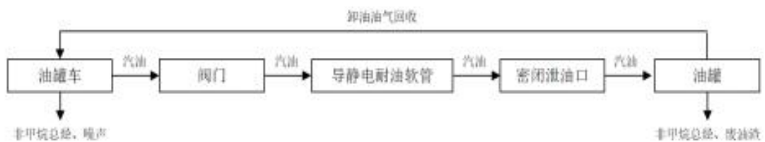
图 1-1 汽油卸油与产污工艺流程图
