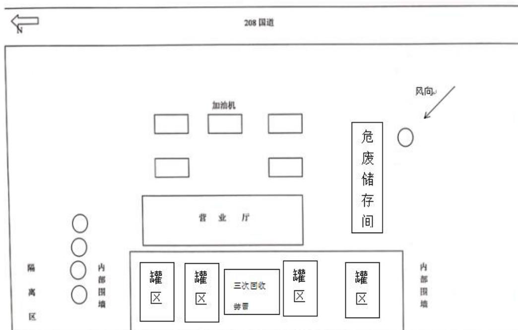
图 3-2 无组织废气监测点位示意图
